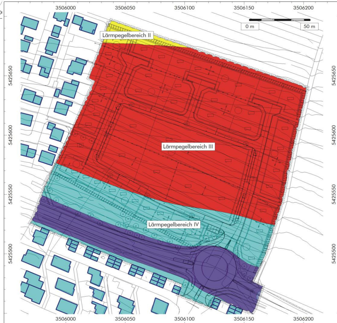
Immissionshöhe 7,5 m über Gelände
